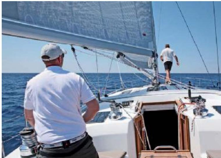
Statt Traveller: Das Großsegel wird über zwei Taljen getrimmt.
