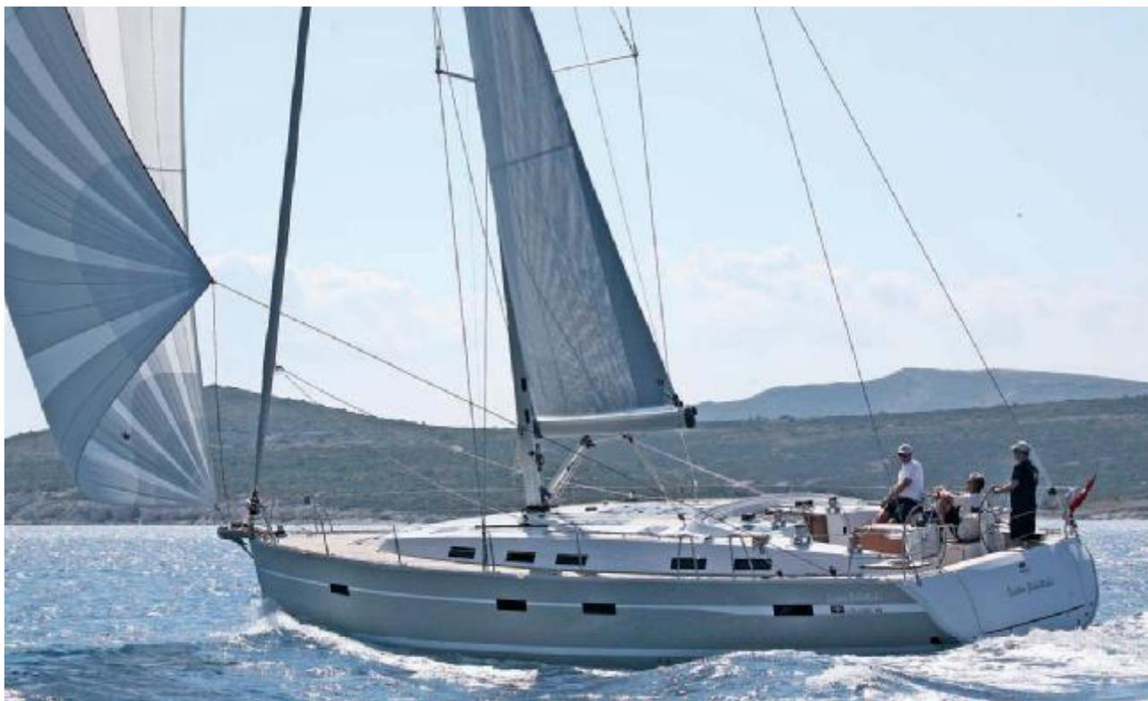
Ein gut proportionierter Rumpf mit viel Volumen im Vorschiff und ein tiefer Schwerpunkt lassen die Bavaria 50 aufrecht und sicher segeln. Eine Doppelrudernanlage für eine ausgeglichene Kursstabilität trägt ebenfalls zur guten Seegängigkeit bei.
