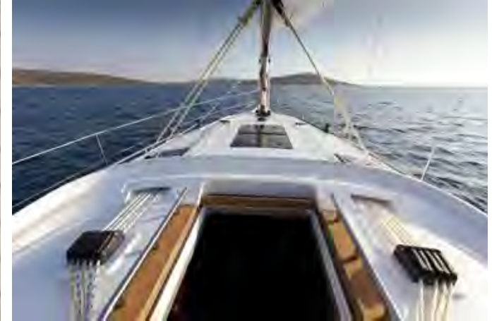
BAVARIA Doppel-Großschotensystem – ermöglicht genaues Trimmen ohne Traveller und sicheres Halsen. BAVARIA double main sheet system – enables exact trimming without traveller as well as safe gybing.
