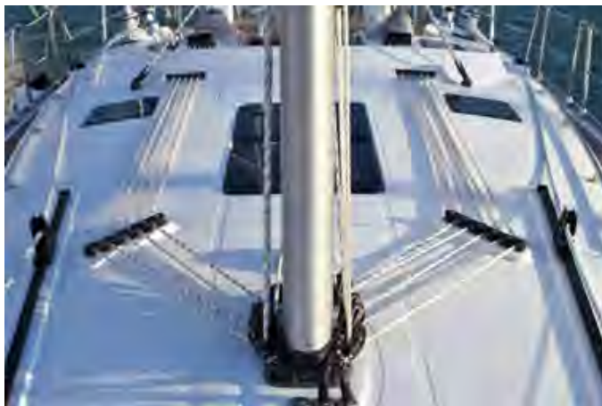
Alle Fallen und Strecker werden sauber ins Cockpit geführt (Bild CR 40)— für die einfache und zentrale Bedienung. All halyards and lines are lead directly into the cockpit for easy and centralized handling.
