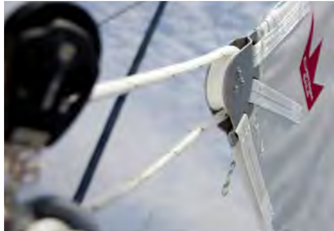
Roll-Groß- und -Vorsegel ermöglichen ein sicheres und leichtes Handling bei allen Schiffsgrößen. Furling main and head sail ensure safe and easy handling for any size of boat.
