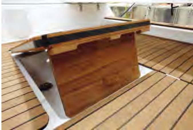
Perfekter Stand für den Steuermann durch ausklappbare Fußstützen (CR 45, 50 & 55). Perfect position for the helmsman thanks to fold-out foot stands (CR 45, 50 & 55).
