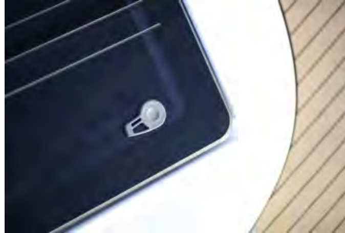
Flush, bündig eingelassene Luken im Deck. Flush hatches ensure an uncluttered deck.
