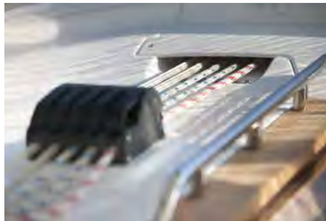
Alle Fallen und Strecker werden sauber ins Cockpit geführt (Bild CR 40)— für die einfache und zentrale Bedienung. All halyards and lines are lead directly into the cockpit for easy and centralized handling.
