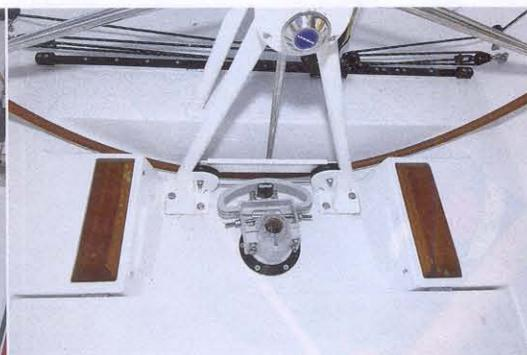
Offengelegt. Der Quadrant ist außen und wird mit einer Klappe abgedeckt
