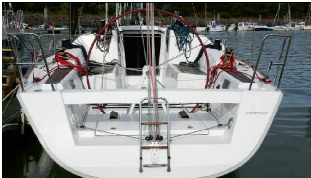
▲ Vu de l'arrière, le cockpit avec, au premier plan, au niveau du fond, le rangement pour la survie. Les winches les plus arrière sont dévolus à l'écoute de GV tandis que ceux de l'avant servent au génois et au spi symétrique.
