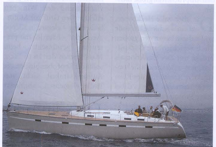
Neben der 106% Genua werden auch eine 130% Genua und eine 90% Selbstwendefock angeboten.
