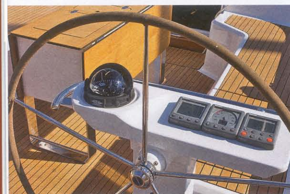
Übersichtlicher Arbeitsplatz: Geräte an der freistehenden Steuersäule
