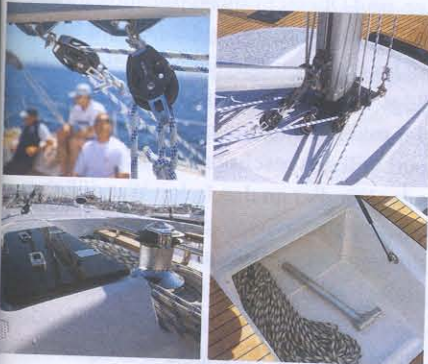
Gute Details: doppelte Schot, direkt laufende Fallen, versenkte Winden und Backskisten für zwei Rettungsinseln
