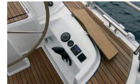
Anche se meglio che sul 55, la soluzione di nascondere comandi e acceleratore sotto una tavoletta apribile continua a non convincerci completamente, perché impedisce di stare seduti sul lato della timoneria quando si naviga a motore
