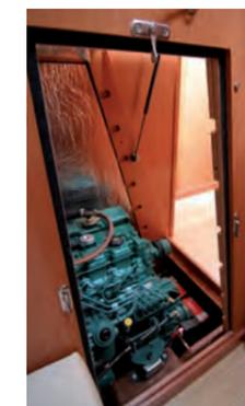
Il vano motore è arioso e ben ispezionabile. A rischio la posizione della batteria, subito sotto la zona delle pompe
