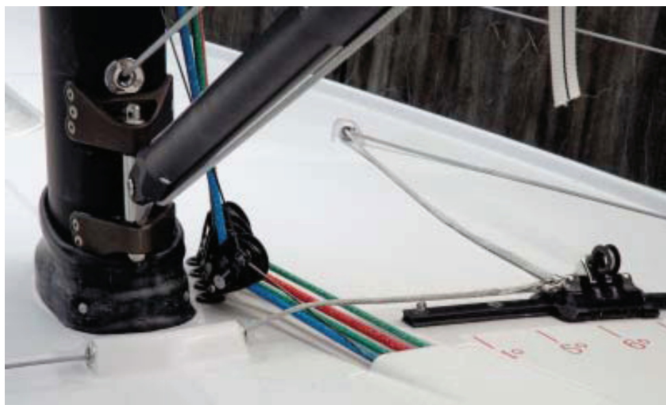
Die Fallen laufen nur einseitig aus dem Mast und verschwinden in einem Kanal, an dessen Ende eine Klemmbatterie vor der Fallwinch montiert ist, die durch den Grinder angetrieben wird. Interessant sind die engen Anstellwinkel der Fock.
