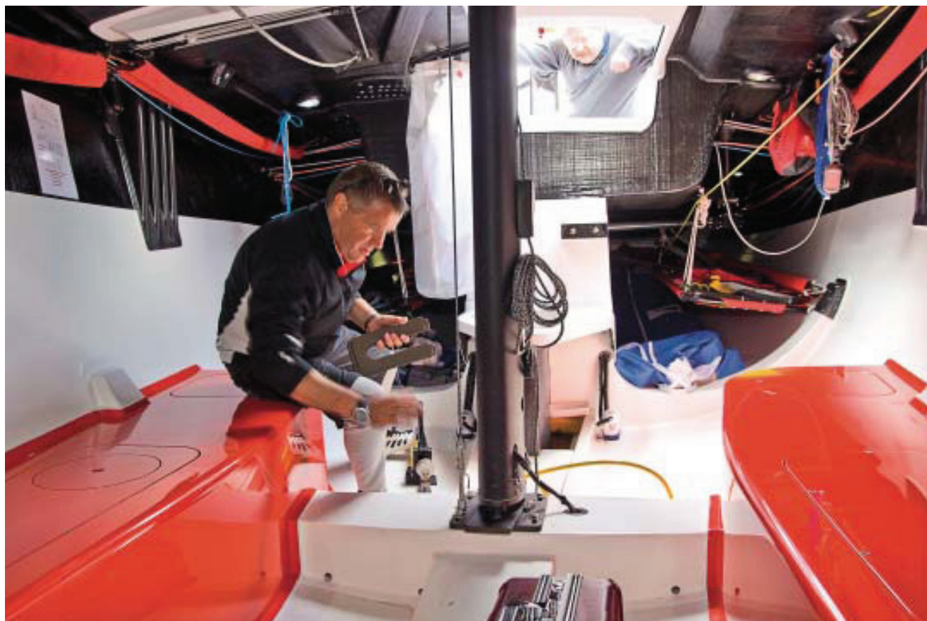
Mit der Hydraulikpumpe wird der Mast angehoben und das Rigg unter Spannung gesetzt. Die U-förmigen Platten kommen als Distanzstücke unter den Mastfuß, um die Hydraulik zu entlasten.
